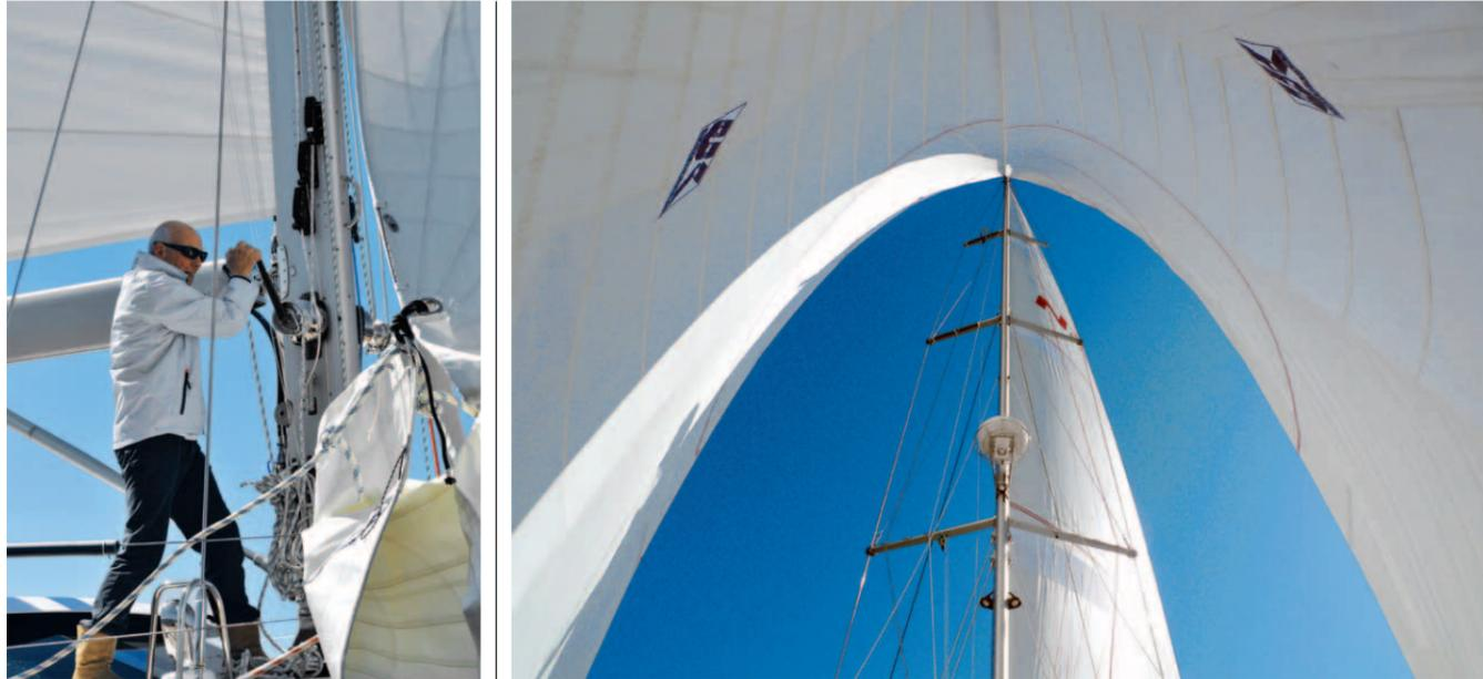
Zum Setzen der Vorsegel ist etwas mehr Kraft nötig, die Vorlieken werden in die Nuten der Rollanlage gefädelt und die Focks mit einem gemeinsamen Fall vorgeheißt. Dabei entsteht deutlich mehr Reibung als mit nur einem Vorsegel
